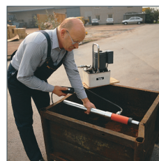
Konténerdoboz kiegyenesítése YS-10/100 hidraulikus henger,AYS-106 toldócső,AYS-103 alapadapter és PY-04/2/5/2 M elektromos tápszivattyú használatával.
