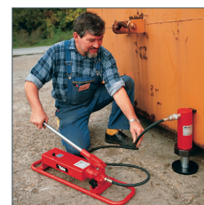
Konténer felemelése YS-23/160 hidraulikus henger,AYS-23 emelőköröm,AYS-232 dugattyúlemez,kétfokozatú HPS-2/2 kézipumpa és tartókeret használatával.
